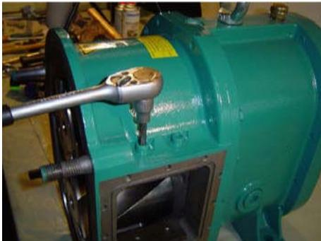
Localiser les vis de fixation des 1/2 coquilles MIP (au dessus et en dessous du corps). Dévisser ensuite les vis à six pans creux.
