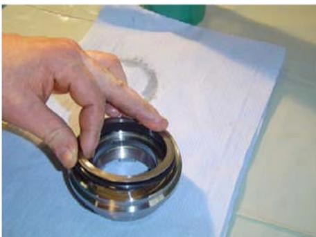
Monter ensuite l'ensemble joint torique et grain tournant dans le support du grain tournant comme indiqué sur la photo.
