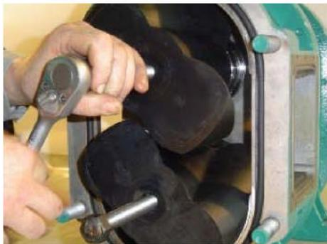
Les deux extracteurs ne sont utilisés que lors de l'emploi de lobes hélicoïdaux en élastomères
