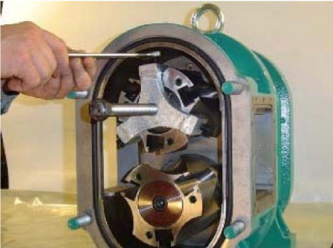
Montage de l'extracteur de tri-lobes et serrage des 3 vis sur le noyau des lobes.
