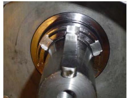
Après avoir positionné le support du grain tournant, insérer la clavette de l'arbre supérieur et s'assurer qu'elle l'entraîne bien. Répétez simplement l'opération pour l'arbre inférieur.
