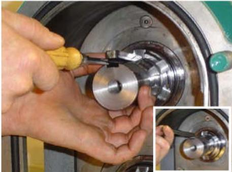
Démonter la clavette sur **un seul arbre** à l'aide d'un tournevis plat large ou d'un outil spécifique
