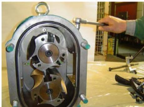
Visser ensuite les vis de fixation des embouts. Visser de façon symétrique afin de plaquer les ½ coquilles sur le corps .
