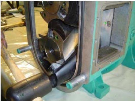
Présenter ensuite l'embout des lobes sur le noyau des lobes. Engagez les deux cales de maintien dans la rainure en T du noyau des lobes. Terminer le montage au maillet et serrez ensuite la vis.
