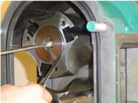
Avant de retirer le noyau des lobes, il est nécessaire d'enlever la rondelle de protection d'arbre. Procédez comme suit : Munissez vous de deux tournevis plat, le tournevis de gauche va s'insérer dans le logement de la vis centrale tout en exerçant une pression angulaire vers l'extérieur tandis que le tournevis de droite va dégager la rondelle de son logement. Répétez ensuite cette opération pour le lobe inférieur
