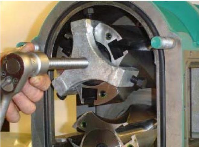
Le vissage de la tige filetée assure le démontage simple et aisé du noyau des lobes.
