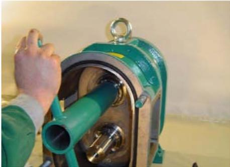
Ainsi le lobe sera plaqué contre le support du grain tournant (pièce tournante et non pas contre la plaque d'usure arrière). Attention ne pas visser jusqu'au fond de filetage.
