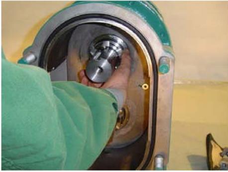
Visser le support du grain tournant jusqu'à ce qu'il soit tangent avec la plaque d'usure arrière. Ensuite, dévisser d'environ 1/6 de tour le support du grain tournant de façon à générer un jeu de 2/10<sup>ème</sup>.
