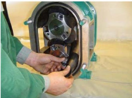
Serrer dans un premier temps la vis centrale à la main. Ensuite utilisez une clef dynamométrique afin de garantir un couple de serrage constant.
