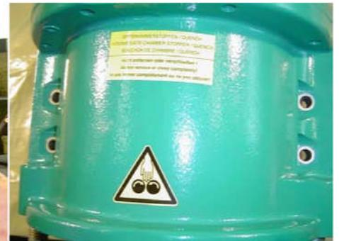
Changer impérativement les joints cuivre assurant l'étanchéité et les vis si nécessaire.
