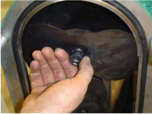
Huiler la vis centrale et la serrer à l'aide d'une clef dynamométrique afin de respecter le couple de serrage prescrit.
