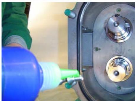
Après avoir positionné la plaque d'usure arrière, enduisez également les vis de pâte à joint afin d'assurer une étanchéité totale.
