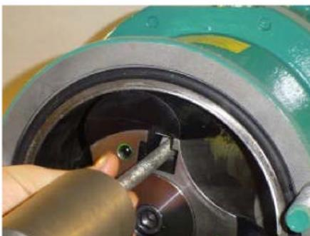
Visser ensuite une tige filetée M12 avec au bout une masselotte afin d'en faire une clef à choc. Effectuer des mouvements rapides vers l'arrière afin de déloger l'embout de la rainure en T située sur le noyau du lobe.
