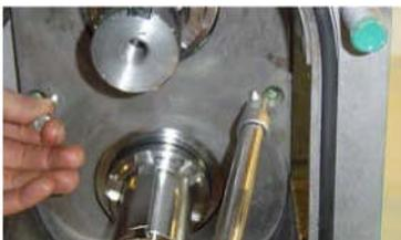
**Retirer la plaque d'usure arrière par les vis d'extraction,**
