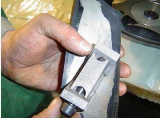
Utiliser la vis et serrer légèrement les deux cales de maintien sur le support de fixation des embouts de lobes
