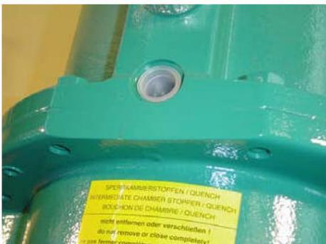
Refermer la chambre intermédiaire avec le bouchon plastique uniquement, **NE PAS OBTURER DEFINITIVEMENT !** Cet orifice doit pouvoir, en cas de rupture de l'étanchéité, laisser migrer le produit pompé à l'extérieur. Ceci assure ainsi une protection efficace contre les dommages sur le bloc de transmission (palier et roulements). Ce palier quant à lui est protégé par une étanchéité radiale.
