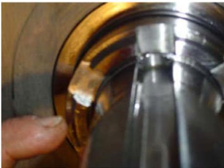
Vérifier que la rainure de clavette de l'arbre soit bien en face de l'encoche du support du grain tournant, de façon à ce que la clavette entraîne en rotation le support du grain tournant
