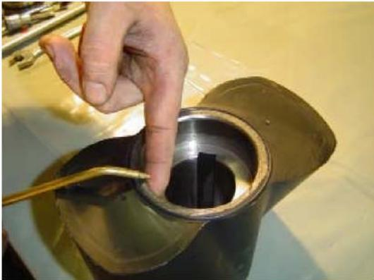
**Préparation :** Nettoyer le lobe et huiler l'arbre de transmission ainsi que l'intérieur du lobe. S'assurer du parfait ajustement de la clavette sur l'arbre.
