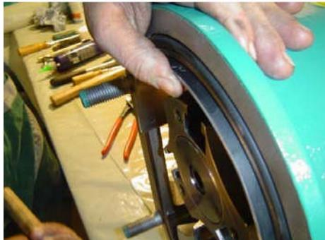
Insérer la nouvelle plaque d'usure radiale à la main.
