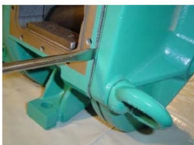
Un écart de 5 mm est suffisant pour faire chuter la pression à l'intérieur du corps. Dévisser ensuite complètement les 4 écrous à oreilles.
