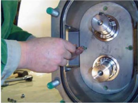
Après avoir resserré les vis de fixation, les lobes peuvent à nouveau être installés dans le corps de pompe.
