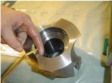
Vérifier et changer le joint torique du support du grain tournant. Huiler ensuite le joint torique ainsi que la partie arrière du lobe prenant appui sur le joint torique (arrière du lobe ou noyau des lobes pour série CL & FL).
