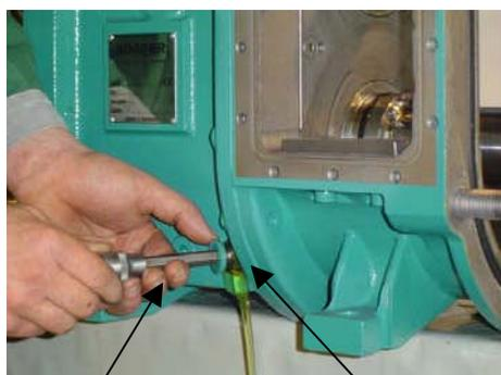
Vidanger l'huile de la chambre intermédiaire (Cf photo) (La vis de vidange est située en bas à droite sur la photo, située au plan de joint du bloc de transmission et du corps de pompe.)
