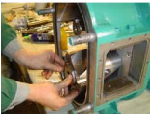
Nettoyer et remplacer le joint torique de la rondelle de protection du noyau de lobes. Huiler également le joint et insérer la rondelle de protection dans l'alésage du noyau de lobe.
