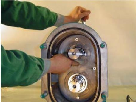
Nettoyer les portées des joints toriques situées sur le grain tournant et également sur le grain fixe. Huiler ensuite les deux portées de joints.
