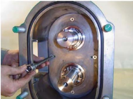
**Dévisser les vis de fixation de la plaque d'usure arrière.**
