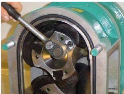
Dévisser la vis à tête hexagonale creuse à l'aide d'une clef alène.
