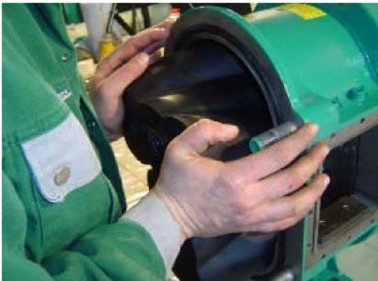
Pour le montage des lobes hélicoïdaux, le montage des lobes supérieur et inférieur doit être simultané.
