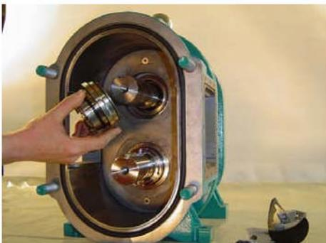
Enlever ensuite le support du grain tournant (support du Grain tournant + joint torique et face de la GM) de l'arbre
