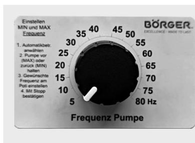
Tourner le potentiomètre (4) en mode manuel permet de commander la fréquence de la pompe d'alimentation
