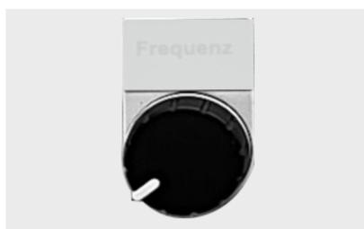
La fréquence de la pompe d'alimentation peut être modifiée en tournant le potentiomètre (4) lors de la période de rodage et lors de l'exécution des programmes de maintenance en mode « Manuel ».
