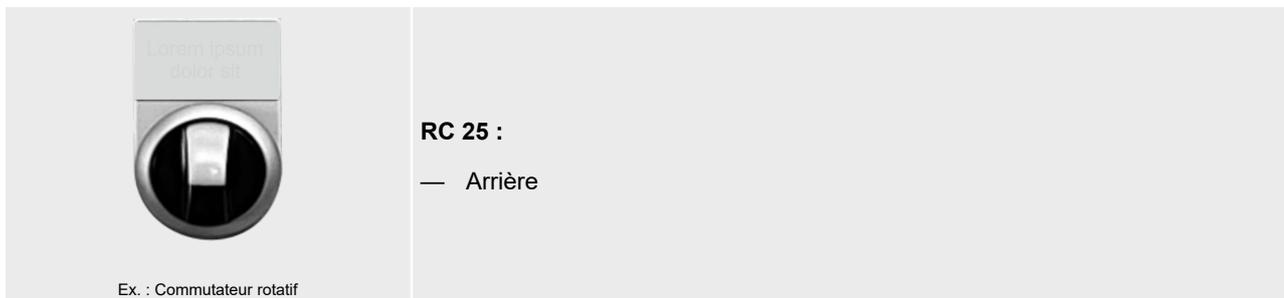
**2. ▶ Maintenez le commutateur rotatif pendant > 5 secondes en position de commutation « **Arrière** »**
