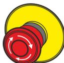
En appuyant sur l'interrupteur D'ARRÊT D'URGENCE, la machine est immobilisée par coupure immédiate de l'alimentation électrique ou par séparation mécanique des entraînements. Après qu'un interrupteur D'ARRÊT D'URGENCE ait été appuyé, ce dernier doit être déverrouillé en le tournant, afin qu'une remise en marche soit possible.
