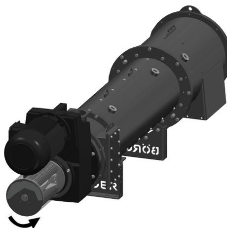
L'arbre de commande sur le Bioselect doit tourner **dans le sens inverse des aiguilles d'une montre**, vue vers l'arrière de la motorisation.
