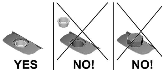
Le bouchon d'évent doit pouvoir être retiré sans pression en cas de débordement du quench. Si la fermeture est fixe et la garniture mécanique endommagée, le substrat qui fuit ne peut pas s'échapper et s'infiltrer donc dans la transmission. La transmission peut alors être endommagée.
