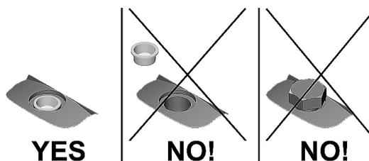
Le bouchon d'évent doit pouvoir être retiré sans pression en cas de débordement du quench. Si la fermeture est fixe et la garniture mécanique endommagée, le substrat qui fuit ne peut pas s'échapper et s'infiltré donc dans la transmission. La transmission risque alors d'être endommagée.
