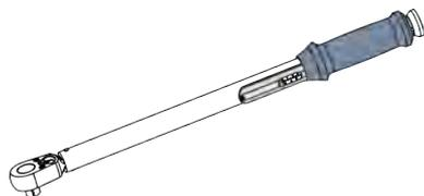
— Une clé de serrage dynamométrique est un outil de vissage manuel, avec lequel un couple de serrage défini peut être exercé sur un élément de raccordement (vis ou écrou), afin que la force de serrage nécessaire entre les composants à raccorder soit également assurée sous des forces de fonctionnement maximales.
