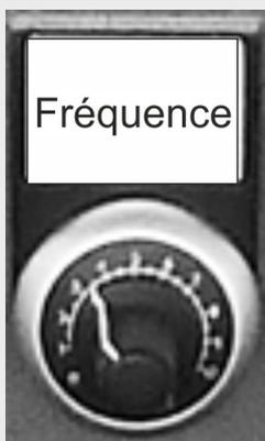
La fréquence du moteur de la pompe d'alimentation peut être modifiée en tournant le potentiomètre (17, « Poti ») lors de la période de rodage et lors de l'exécution des programmes de maintenance conformément au [Chapitre 5.2 « Mode automatique et mode manuel »](#) à la page 95 en mode de fonctionnement manuel (mode de fonctionnement « Mode manuel »).
