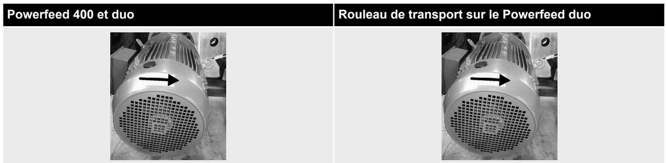
Sur les **Powerfeed 400 et duo** avec réducteur à arbres parallèles à trois niveaux, la roue de ventilateur doit tourner **dans le sens des aiguilles d'une montre**, si la vis sans fin tourne correctement dans le sens contraire des aiguilles d'une montre.
