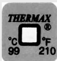
**Signification :** Bandes thermométriques pour le contrôle de la température de surface à la transmission de la pompe :
