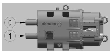
Figure 3.1.4 Position d'arbre de commande
