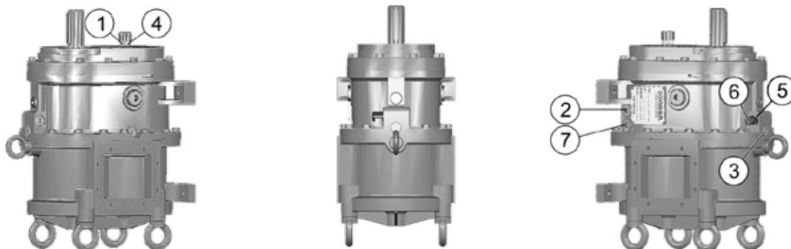
Dans le cas **du modèle submersible** (modèle spécial), les ouvertures de remplissage et de ventilation avec prolongation de tube sont installées dans la partie visible ou peuvent être totalement obturées en option, en fonction de l'utilisation.
