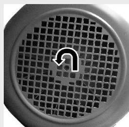
⇒ sens de rotation nécessaire de l'arbre/de la roue de ventilateur **en regardant sur la motorisation** : dans le sens contraire des aiguilles d'une montre
