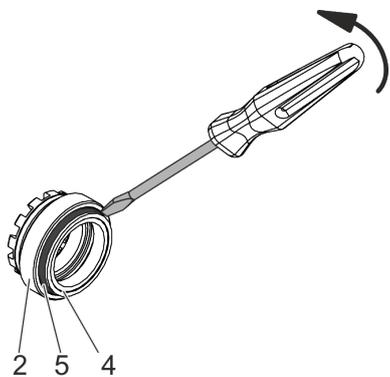
**7.** ▶ Retirez la face de frottement (4) avec le joint torique (5) du support de grain tournant respectif (2).
