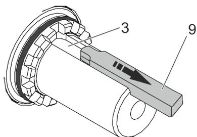
**5.** ▶ Utilisez un outil approprié (par ex. un tournevis plat) pour retirer la clavette (9) de la rainure de clavette (3) de l'arbre. Veillez à ne pas endommager les clavettes.
