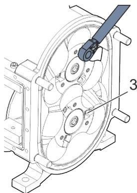
**27.** Mettez prudemment l'embout amovible (9) en position définitive et correcte avec un maillet en plastique. Les embouts amovibles arrières doivent affleurer le noyau de lobe. Les embouts amovibles ne doivent ni dépasser ni être trop enfoncés.
