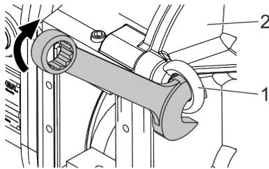
**19. → Serrez uniformément et en croix les écrous à oreille (1) à l'aide d'un tournevis, en veillant à ce que le joint torique (4) reste intact et sur la même position.**
