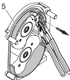
**5.** Pour retirer la plaque d'usure radiale (5), faites prudemment levier avec un tournevis plat inséré sous la plaque d'usure radiale.
