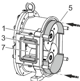
**10.** Installez les plaques d'usure radiales (5) symétriquement dans le corps de pompe. Relevez les embouts de fixation inférieurs pour ce faire.
