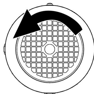
Sens de refoulement **de la gauche vers la droite**, lorsque l'arbre supérieur tourne dans le sens contraire des aiguilles d'une montre
