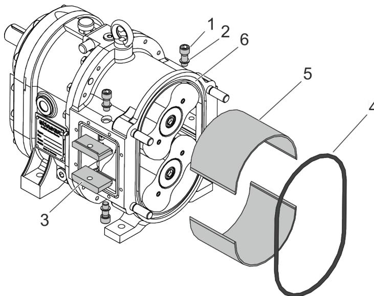
Fig. 10 : 063X\_DKP\_Coques de protection du corps Assemblage
