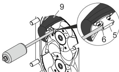
**5.** ➔ Vissez une tige filetée adaptée avec un extracteur à inertie dans le filetage (6) de l'embout de fixation (5).
