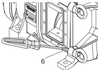
5. ➤ Desserrez ou retirez les goupilles cylindriques (8) à l'aide d'une tige filetée avec extracteur à inertie.
