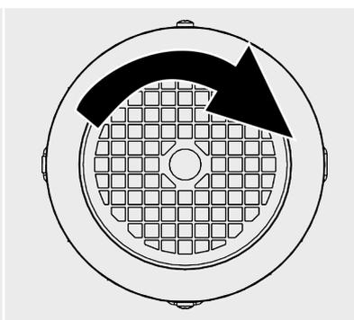
Sens de refoulement **de la droite vers la gauche** lorsque l'arbre supérieur tourne dans le sens contraire des aiguilles d'une montre
