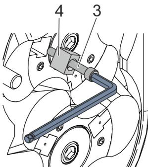
**4.** ➔ Desserrez la vis à tête cylindrique (3) avec une clé pour vis à six pans creux et retirez-la à l'aide de la cale de blocage (4).
