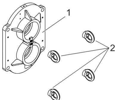
Le principe MIP de Börger (Maintenance in Place) commence par le flasque de contre-palier (1). Ce flasque permet d'accéder facilement à l'intérieur du corps et à toutes les pièces d'usure de la machine Börger qui s'y trouvent. Les conduites à l'entrée et à la sortie peuvent rester raccordées.
