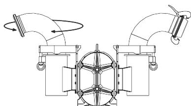
— **Raccord d'aspiration et de refoulement rotatif en continu sur 360°**
