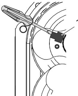
**3.** ➔ Retirez le bouchon en T (1) en faisant levier à partir de la rainure à l'aide d'un tournevis.
