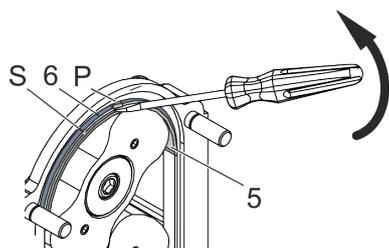
**4.** Pour ne pas endommager l'arête [S] entre l'ouverture de pompe et la rainure de joint torique (6), retirez le joint torique (4) et bloquez une clavette [P] ou autre moyen similaire dans la rainure (6) avant d'opérer avec un outil.
