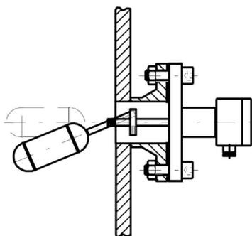
Fig. 12 : Ex. interrupteur à flotteur
