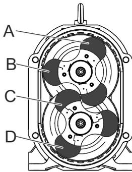
**1.** ➔ En présence de lobes **hélicoïdaux**, placez le premier embout amovible à démonter dans une position non engrenante [ A, B, C ou D] en le tournant l'arbre de commande avec une clé pour vis à six pans creux ou un cliquet dans le sens horaire.
