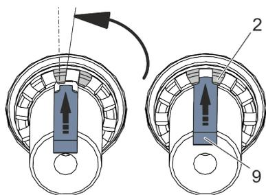
**20.** → Installez la clavette (9) de manière qu'elle s'enclenche dans la rainure du support de grain tournant (2) et dans celle de l'arbre (3). Le côté de la clavette doit saisir avec le tenon en haut dans le support du grain tournant. Si la clavette est en deux ou trois parties et une des clavettes a une face avant droite, celle-ci doit être dirigée vers le flasque à fermeture rapide.
