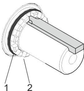
**21.** → Mettez le joint torique neuf (1) en place sur le support du grain tournant (2). Ne réutilisez l'ancien joint torique que si tout endommagement peut être exclu.
