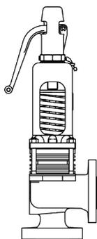
Fig. 11 : Ex. soupape de sûreté
