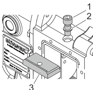
**7.** Des joints (2) se trouvent sous les vis à six pans creux (1). Remplacez-les si leur endommagement ne peut pas être exclu. Enlevez les embouts de fixation (3) des lobes démontés pour ce faire.
