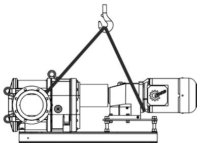
Les machines Börger de type EL avec motorisation électrique en formes de construction standard peuvent être transportées en toute sécurité comme cela est illustré ici.
