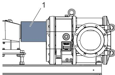
5. ➤ Si cela est nécessaire, corrigez prudemment l'alignement de l'accouplement, par exemple à l'aide des vis de réglage de la plaque moteur, et conformément aux indications du fabricant de l'accouplement.
