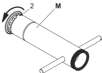
**6.** ▶ Dévissez respectivement le support du grain tournant (2) à l'aide de la clé spéciale (M) et retirez-le de l'arbre.
