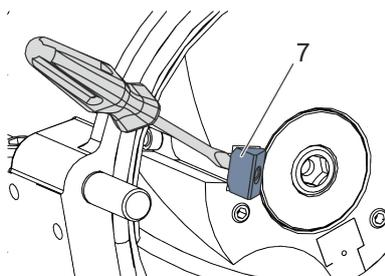
**7.** ➔ Retirez la deuxième cale de blocage (7), par ex. à l'aide d'un tournevis ou d'un extracteur à inertie avec une tige filetée adaptée.
