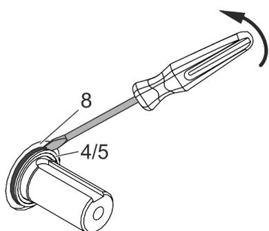
**8.** ▶ A l'aide d'un outil adapté, (par ex. tournevis) retirez les faces de frottement de garniture mécanique (4) et les joints toriques (5) des supports du grain fixe (8) restants dans la machine Börger.
