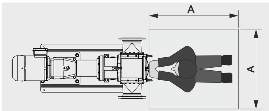
L'unité en version standard est livrée prête à l'emploi, montée sur un châssis résistant au gauchissement avec accouplements élastiques, protège-accouplement et brides.
