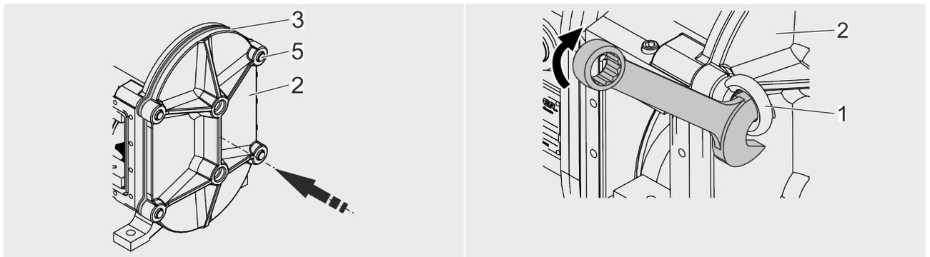
14. ➤ Poussez le flasque à fermeture rapide (2) sur les goujons (5) et fixez-le à l'aide des écrous à oreille (1).
