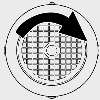
⇒ sens de rotation nécessaire de l'arbre / de la roue du ventilateur **en regardant sur la motorisation : dans le sens des aiguilles d'une montre**
