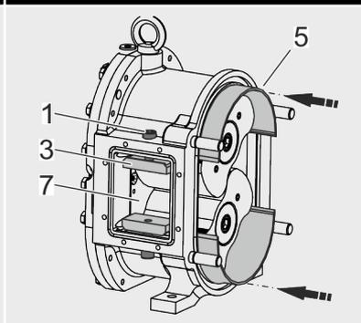
8. ► Nettoyez le corps de pompe, les embouts de fixation (3) et les surfaces d'appui.
