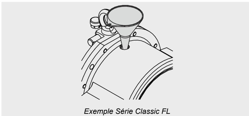
2. Remplissez le lubrifiant jusqu'au niveau de remplissage optimal sous respect des indications dans le [Chapitre 9.8 « Liste des lubrifiants »](#) à la page 195.
