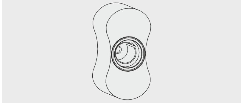
11. Enduisez les alésages d'ajustement des lobes ainsi que, dans le cadre des valeurs de résistance et de la compatibilité avec le fluide, le joint torique (7) du support du grain tournant d'huile / de lubrifiant approprié(e).
