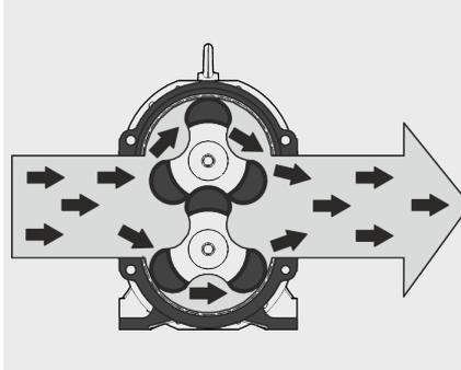
Sens de refoulement **de la gauche vers la droite**, lorsque l'arbre supérieur tourne dans le sens contraire des aiguilles d'une montre
