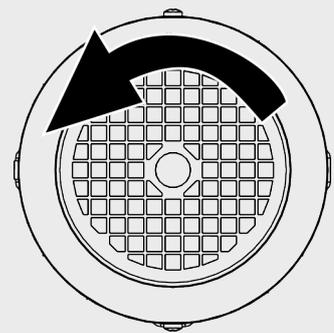
⇒ sens de rotation nécessaire de l'arbre / de la roue du ventilateur **en regardant sur la motorisation : dans le sens inverse des aiguilles d'une montre**
