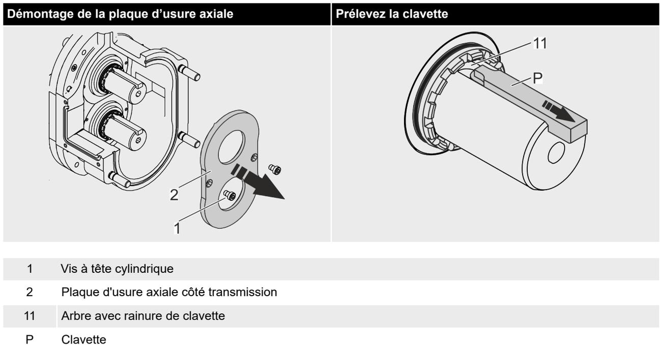
3. ➔ Utilisez un outil approprié (un tournevis plat, par exemple) pour retirer la clavette (P) de la rainure d'arbre (11). Veillez à ne pas endommager les clavettes.
