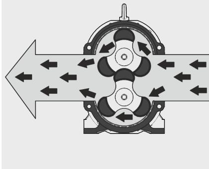
Sens de refoulement **de la droite vers la gauche**, lorsque l'arbre supérieur tourne dans le sens contraire des aiguilles d'une montre
