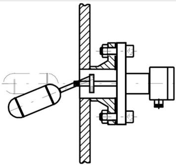
Les interrupteurs à flotteur et les interrupteurs magnétiques à flotteur permettent de surveiller le niveau ou de commander le niveau de remplissage et, selon le modèle, peuvent également être utilisés comme protection contre la marche à sec.
