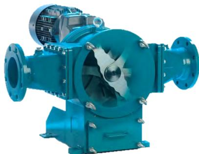
Le Rotocrusher Börger est un appareil de broyage compact de conception Inline. Les couteaux et les contre-couteaux sont disposés alternativement sur l'arbre de commande. Les contre-couteaux sont fixes et ne peuvent pas tourner. L'arbre rotatif est entraîné par l'unité d'entraînement et par l'unité support.
