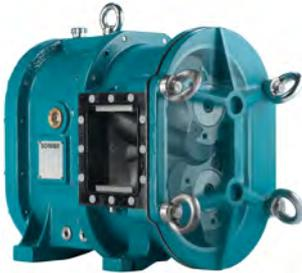
Les pompes à lobes Börger sont volumétriques, à amorçage automatique à sec et sans soupapes. Elles refoulent des fluides de différentes consistances ainsi que des mélanges de plusieurs phases, et cela en continu et sans pulsations avec des débits proportionnels à la vitesse de rotation. Elles présentent une construction compacte et refoulent le fluide en douceur et avec peu de pulsations.
